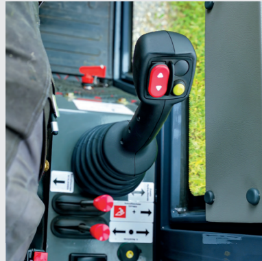
Joystick-Steuerung und elektronische Gangschaltung
