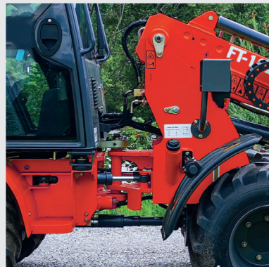
Knickpendelgelenk für mehr Flexibilität und Bodenhaftung
