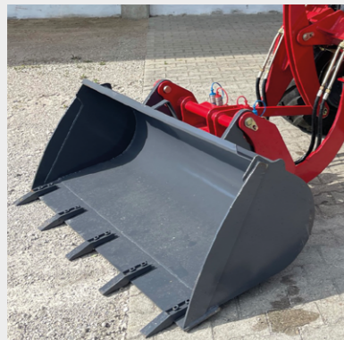
Inklusive 0,4 m³ große Erdschaufel mit abnehmbaren Zähnen
