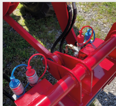
Schnellwechsler für schnelles Tauschen der Anbauwerkzeuge, Opt. 4er Steuerkreis doppelt wirkend
